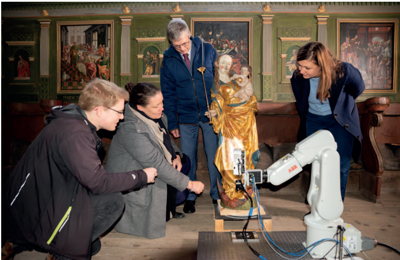
Das Verfahren tastet Holzskulpturen erstmalig mit einem Roboterarm dreidimensional ab und übernimmt die Messergebnisse in eine neuartige Tiefenkartierung; v.l.: Cornelius Mach, Dr. Kirsti Krügener, Prof. Dr. Wolfgang Viöl und Constanze Fuhrmann, Deutsche Bundesstiftung Umwelt. © HAWK, Alissa Lange
